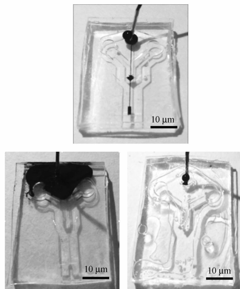
图6 微流芯片封装测试对比
